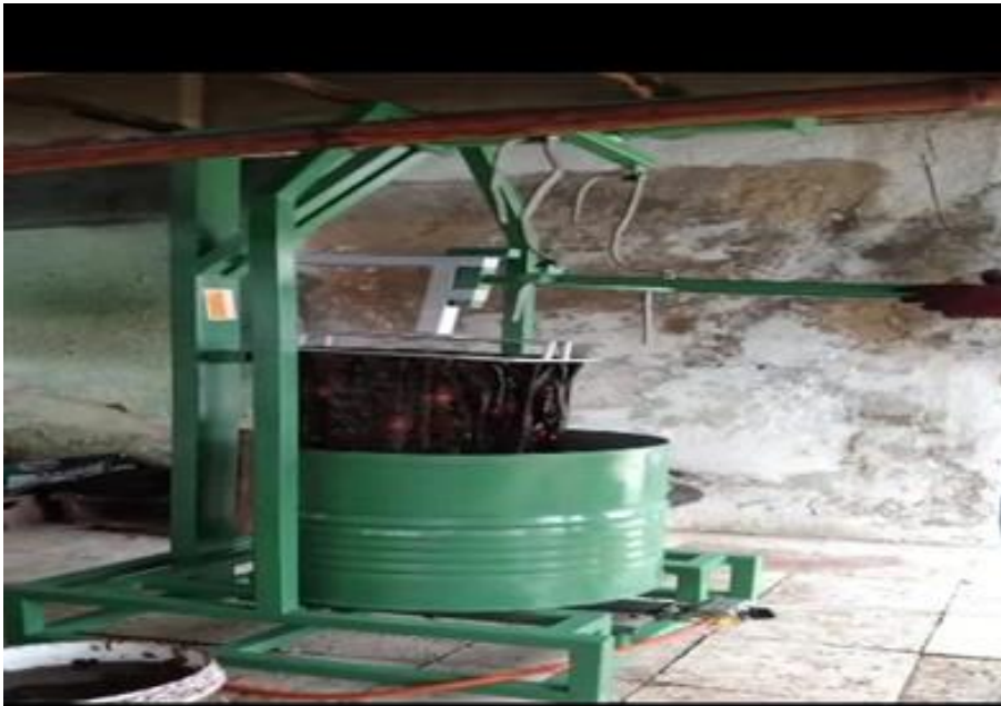
Gambar 3. Proses Lorot menggunakan mesin plorot
